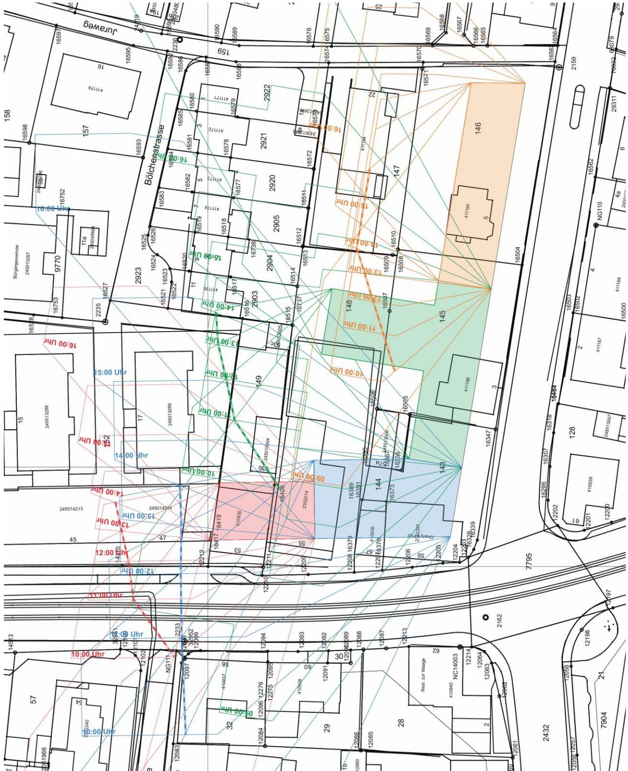
2-Stunden-Schatten des Baufelds B (blaue Linie) am mittleren Wintertag (8. Februar) sowie hypothetische Vergleichsvariante (pinke Linie: 2-Stunden-Schatten bei 5-geschossiger Bebauung des Baufelds B)
