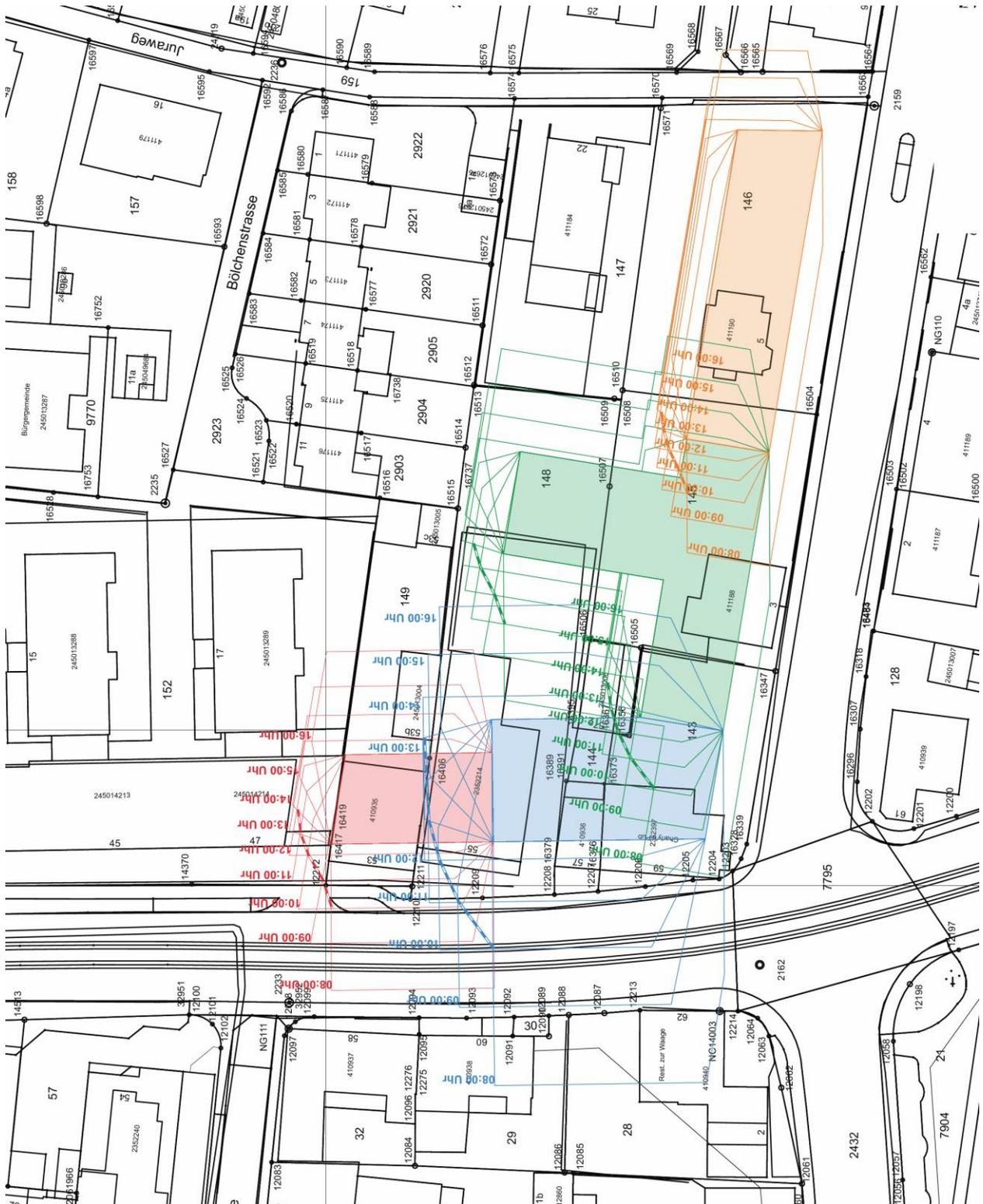
2-Stunden-Schatten des Baufelds B (blaue Linie) zum Sonnenhöchststand (21. Juni) sowie hypothetische Vergleichsvariante (pinke Linie: 2-Stunden-Schatten bei 5-geschossiger Bebauung des Baufelds B)
