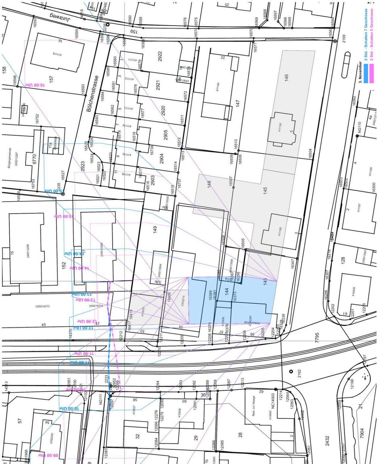
2-Stunden-Schatten der Gebäudetrakte A1 (rote Linie), A2 (grüne Linie), B (blaue Linie) und C (orange Linie) zum Sonnentiefststand (21. Dezember)
