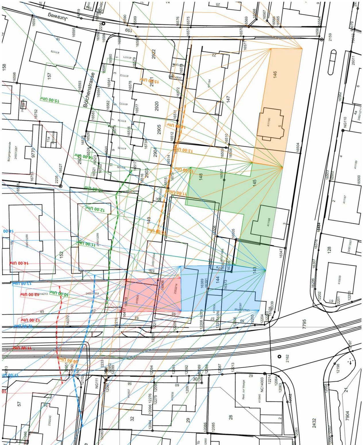
2-Stunden-Schatten des Baufelds B (blaue Linie) zum Sonnentiefststand (21. Dezember) sowie hypothetische Vergleichsvariante (pinke Linie: 2-Stunden-Schatten bei 5-geschossiger Bebauung des Baufelds B)
