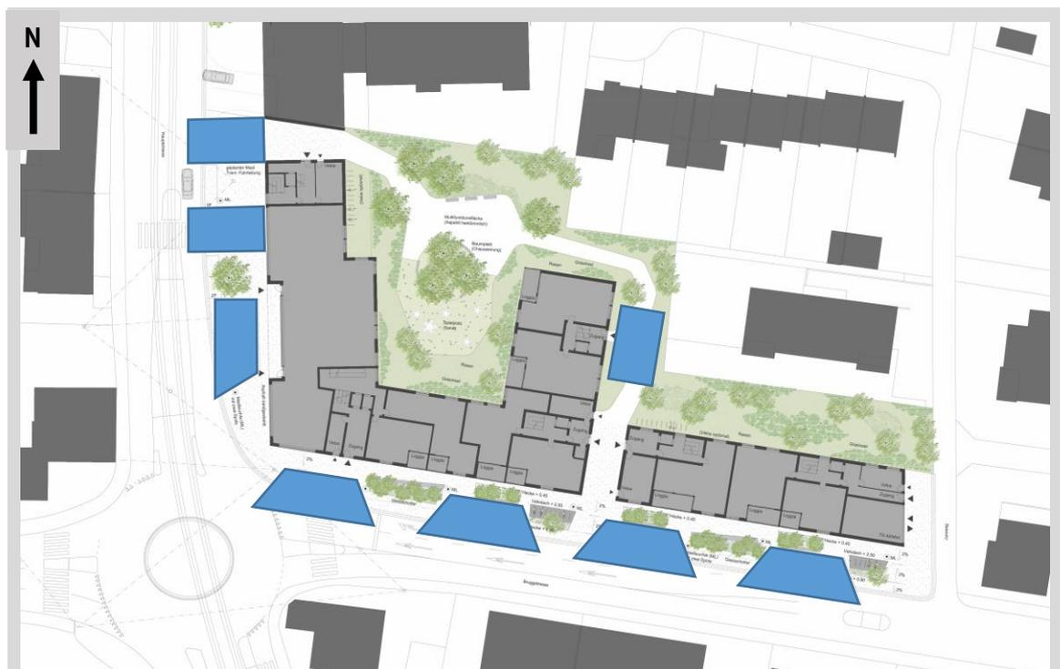
Abbildung 9: Aussenraumplan mit Aufstellflächen der Feuerwehr (blau hervorgehoben). Stauffer Rösch Landschaftsarchitekten 11./28. Januar 2016.
